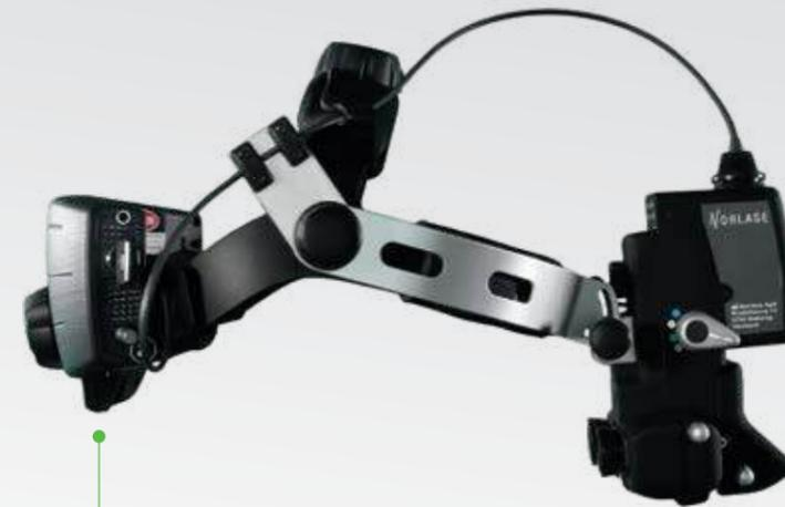
El láser y los dispositivos electrónicos de control se encuentran en el casco de LION.
